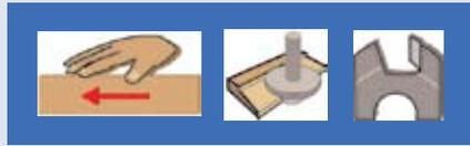
Anwendung: Zum planen Überfräsen von abstehenden Deckschichten, Umleimern etc.
